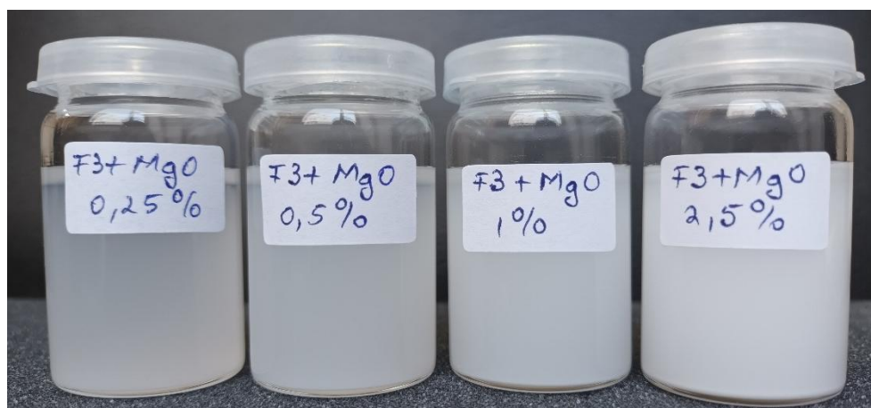
Figura 3. Nanofluidelile F3 + MgO, după 48h.
