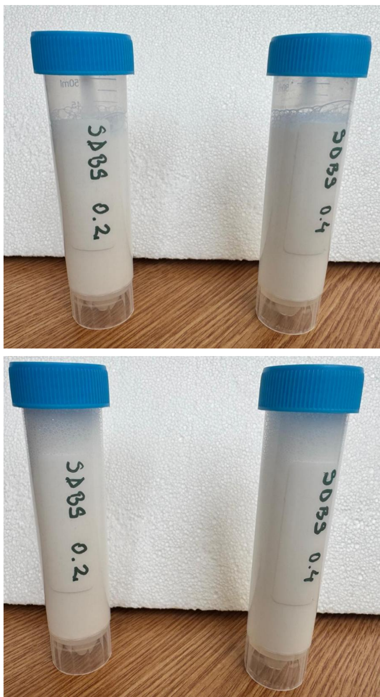
Figura 15. Probe suplimentare cu surfactant SDBS, cu evidențierea spumei create
