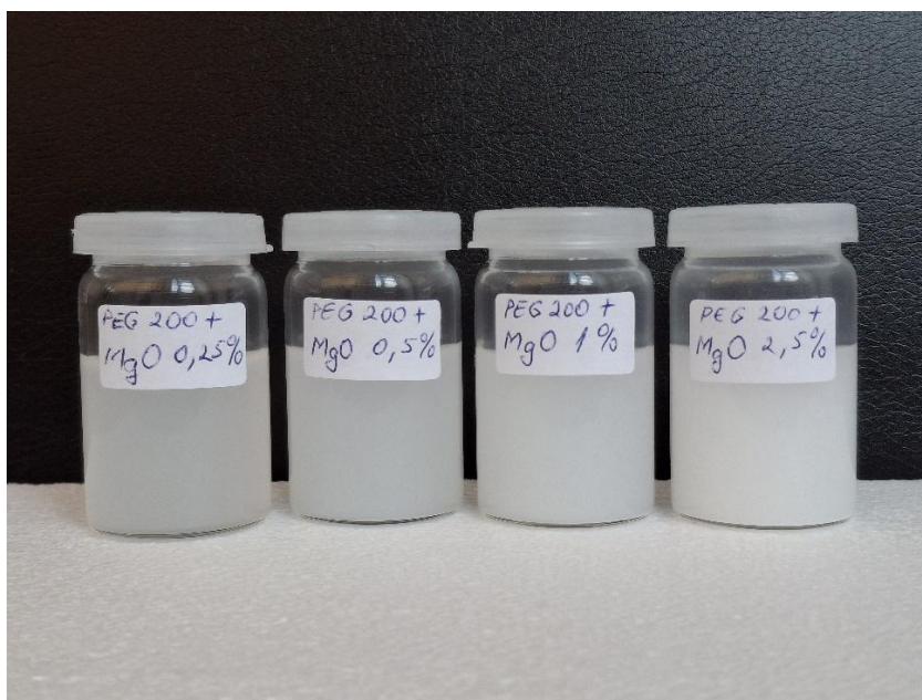
Figura 1. Nanofluidele pe bază de PEG 200 + MgO
